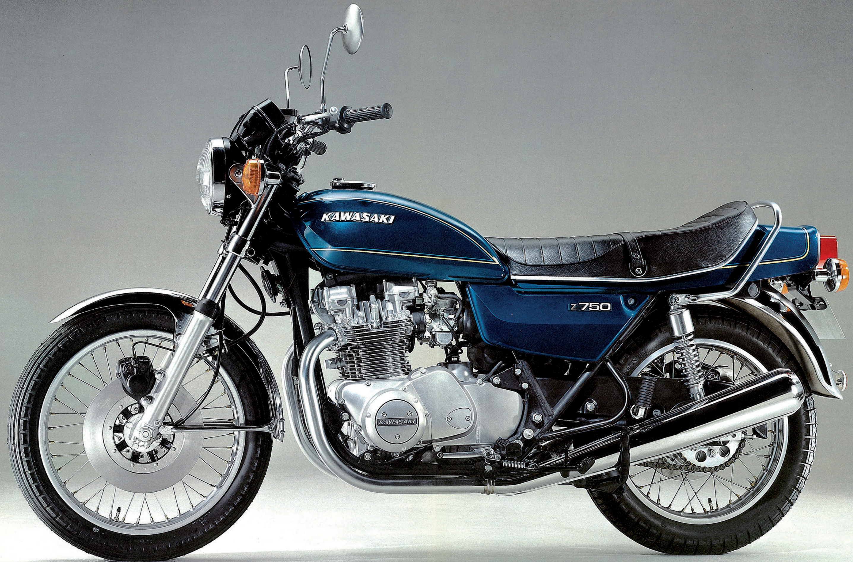
740 ccm, zwei obenliegende Nockenwellen, 50 PS, Zweizylinder-Viertakt, Scheibenbremse vorn
